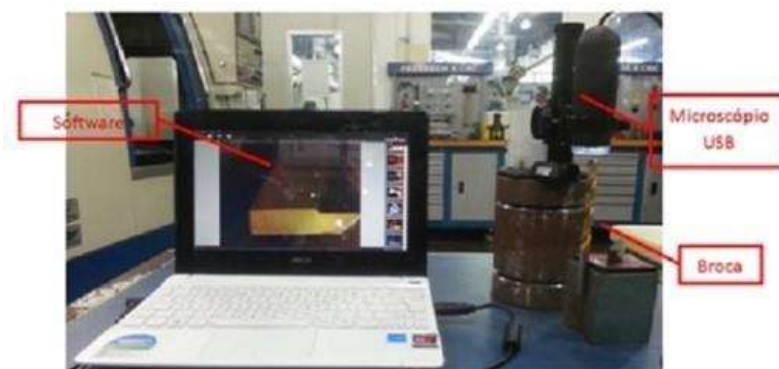
Figura 2 - Medição do desgaste do flanco com microscópio e software
