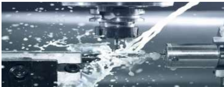
Figura 1 - Processo de fresagem refrigerado pela técnica abundante
