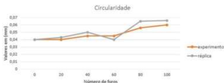
Gráfico 3 - Erros de circularidade das brocas de aço rápido com furo de centro
