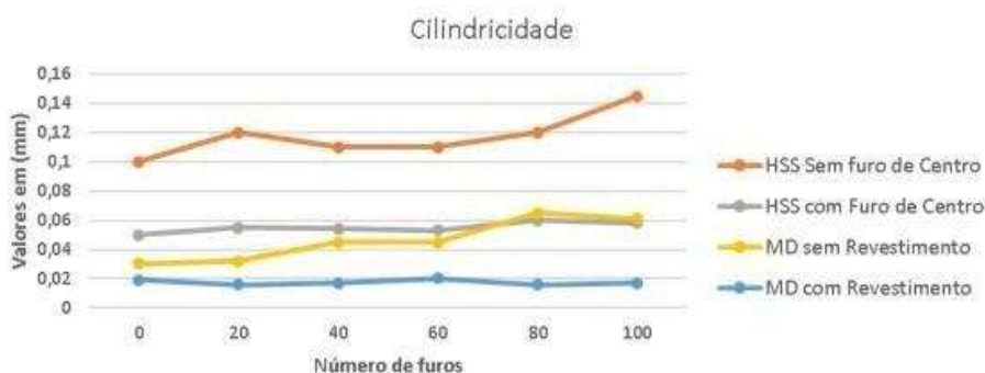
Gráfico 5 - Variação de cilindridade para às quatro brocas
