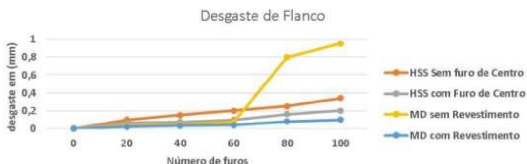
Gráfico 1 - Desgaste do flanco ao longo do comprimento usinado
