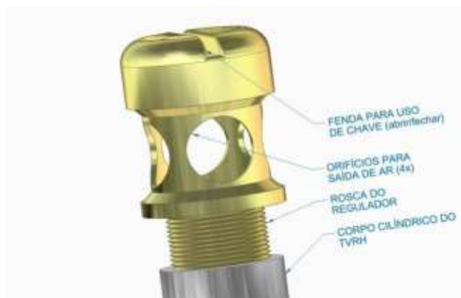
Figura 4 - Regulador fluxo saída, ar do Tubo Vórtice
