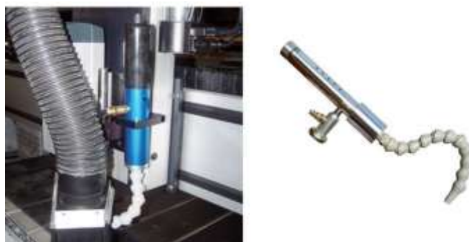
Figura 3 - (Esq.) Sistema Tubo Vórtice adaptado no cabeçote do CNC, (Dir.) Tubo Vórtice de Ranque-Hilsch.
